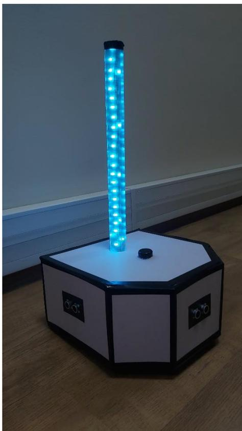
Рисунок 3.2 – Дезинфекция ультрафиолетом
